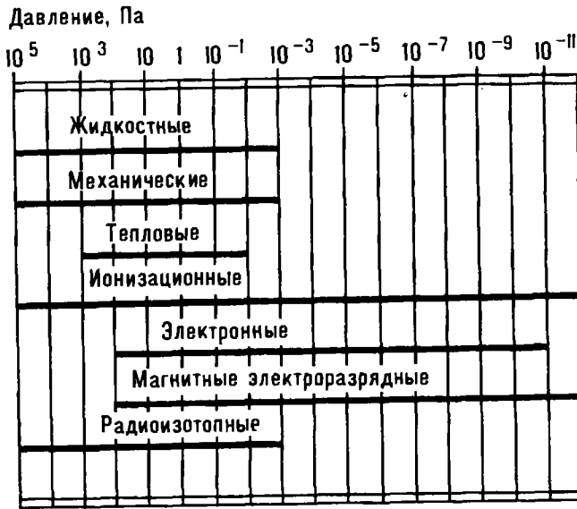
Диапазоны давлений, измеряемых различными вакуумметрами
