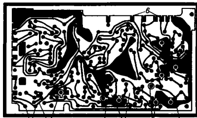
Печатная плата: 1 - контактные площадки; 2 - печатные проводники тока; 3 - участки фольгированной поверхности; 4 - электроизоляционные промежутки; 5 - металлизированные отверстия; 6 - контактные площадки для соединения с внешними электрическими цепями
