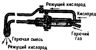
Резак для кислородной резки
