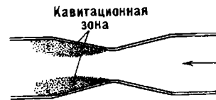
Кавитационная зона в трубке с местным сужением
