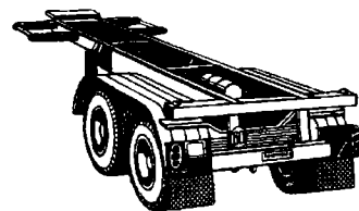
Контейнеровоз грузоподъемностью 20 т
