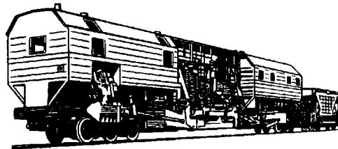
← Выправочно-подбивочно-отделочная машина ВПО-3000 с производительностью 3000 м/ч
